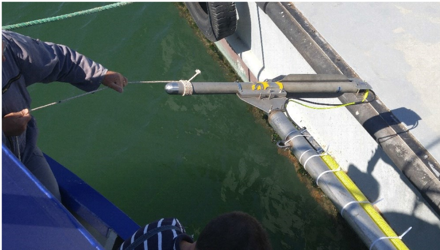
Şekil 2. 100/325 kHz Frekanslarında Çalışabilen C-MAX CM2 Yanal Taramalı Sonar
