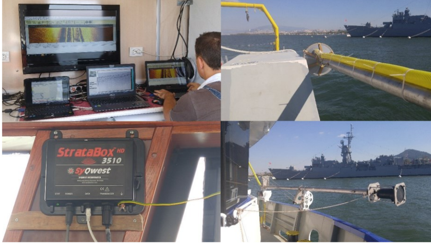
Şekil 3. 3,5 kHz'lik ve 10 kHz'lik Stratabox Sub Bottom Profiler Cihazları ve Teknik Çalışma Alanı
